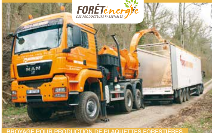
BROYAGE POUR PRODUCTION DE PLAQUETTES FORESTIÈRES
