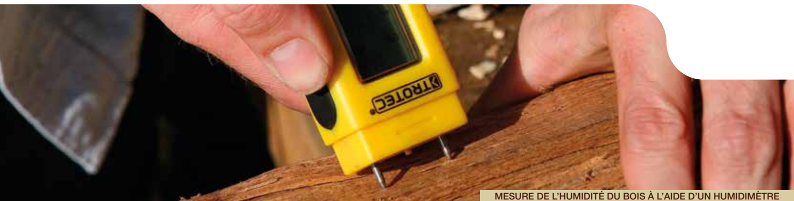
MESURE DE L'HUMIDITÉ DU BOIS À L'AIDE D'UN HUMIDIMÈTRE
